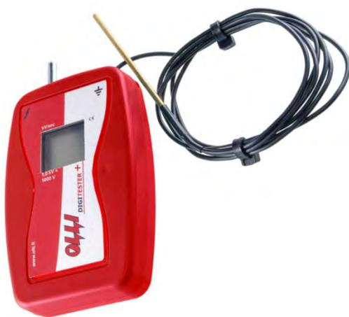
Olli Digitester+ – это оснащенный цифровым дисплеем тестер для электроизгороди, который четко отображает уровень напряжения (кВ) в изгороди в числовом виде. В комплект входит батарейка 9 В.
