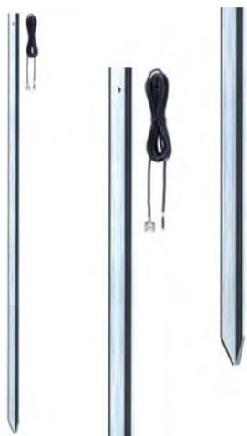
Оцинкованный методом горячего цинкования шест заземления для электропастуха, длина 1 м. Заостренный L-профиль на конце. Включает соединительный кабель длиной 3 м с крепежными винтами. Установите шест полностью под землю.
