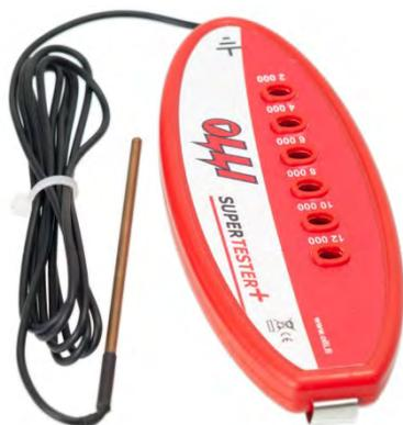
Olli Supertester+ – это тестер для изгороди с шестиступенчатым световым дисплеем. Дисплей отображает величину напряжения в электроизгороди в диапазоне от 2000 до 12 000 В. Тестер не требует отдельной батарейки, получая питание прямо от проверяемой изгороди.
