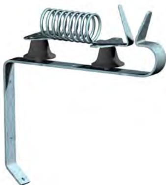
Грозозащитный разрядник защищает ваш электропастух от разрядов молнии, поступающих через изгородь, направляя молнию перед электропастухом в землю. Устанавливается между изгородью и электропастухом. Оцинкован методом горячего цинкования.
