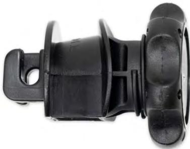
Изолятор для провода на стекловолоконные столбики и арматуру представляет собой пластиковый изолятор для провода диаметром макс. 5 мм. Изолятор снабжен быстросъемным ленточным замком. Подходит для стекловолоконных и металлических столбов диаметром от 8 до 14 мм. Стяжное кольцо предотвращает вращение и скольжение. Размер упаковки 25 шт.
