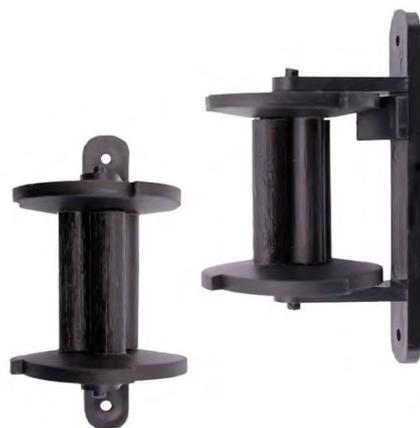
Натяжитель для лент для оград сохраняет ленты прямыми и предотвращает их спутывание. Равномерно натягивает ленту с обоих концов. Подходит для любой ширины лент (12 мм, 20 мм и 40 мм) и для зимней ленты 40 мм Olli. Ленту можно натянуть вручную, без инструментов. В упаковке – 2 натяжителя, крепление к столбику ограждения двумя винтами.
