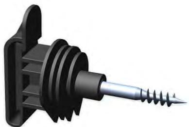
Изолятор для лент для оград – шириной от 12 до 40 мм крепится ввинчиванием. Изолятор оснащен быстродействующим замком для лент. Размер упаковки – 100 шт., упаковка содержит устанавливаемый в патрон дрели инструмент для крепления кольцевых и ленточных изоляторов.
