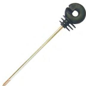
Выносной изолятор – это кольцевой изолятор на штыре со стальным стержнем длиной 19 см. Выносной изолятор позволяет удерживать животных на большем расстоянии от электроизгороди. Подходит для шнуров и тросов для ограды.
