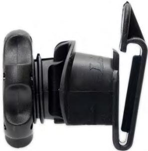
Изолятор для ленты на стекловолоконные столбики и арматуру представляет собой пластиковый изолятор для лент шириной 12–40 мм. Изолятор снабжен быстросъемным ленточным замком. Подходит для стекловолоконных и металлических столбов диаметром от 8 до 14 мм. Стяжное кольцо предотвращает вращение и скольжение. Размер упаковки 25 шт.
