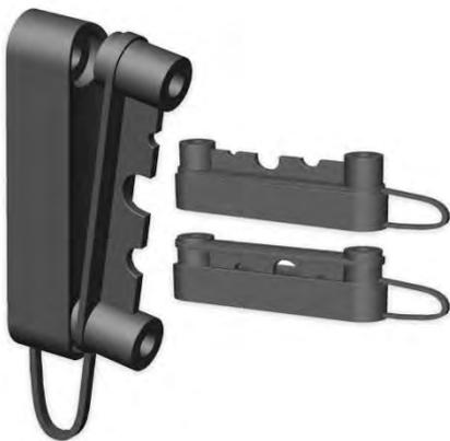
Изолятор Duo – это многоцелевой изолятор для любых шнуров, лент и тросов для ограды Olli, а также для их разветвлений. Крышку можно повернуть в два положения в зависимости от используемого в ограждении проводника (шнур, трос или лента). Изолятор с очень высокой механической прочностью. Крепление двумя винтами, рекомендация для винта: с полукруглой головкой 4,5 × 50 мм.
