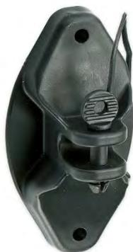
Изолятор с замком для стального провода и троса для изгородей из стального провода High Tensile. Подходит для канатов и стальных тросов не более 8 мм. Подходит также для изгородей, в которых стальной провод используется только в некоторых элементах шнуров для ограды. Крепление 2 гвоздями или винтами. В упаковке – 25 шт.
