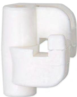
Изолятор ответвления представляет собой недорогой изолятор для шнуров и тонких лент, крепящийся с помощью гвоздя или винта. Атмосферостойкий белый специальный полипропилен с защитой от УФ-излучения. В упаковке – 100 шт. Произведен в Финляндии.
