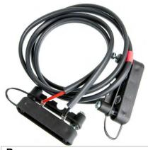
Перекидной кабель для соединения ярусов зимней ленты надежно соединяет разные ярусы изгороди, построенной из зимней ленты. Перекидной кабель для соединения ярусов зимней ленты соединяет отдельно «ударный» и заземляющий провода зимней ленты. Длина соединительных кабелей — 65 см. «Ударный» провод обозначен красным цветом. 1 шт. / упаковка.
